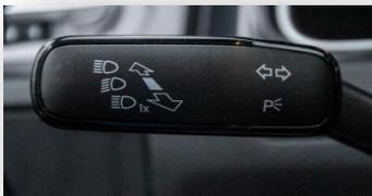
Hebel auf/ab: Blinker rechts/links
