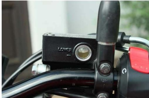
Dichtheitsprobe: Bremshebel für 30 Sekunden betätigen, darf nicht nachgeben!
