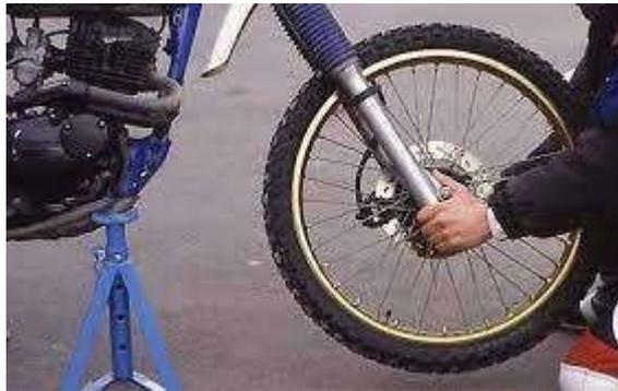
Radlager: Bei entlastetem Rad versuchen, es quer zur Fahrtrichtung zu bewegen.
