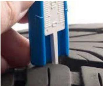
Bei der Kontrolle mittels Tiefenwertindikator: Wenn der Indikator und das Profil eine Ebene bilden, ist die Mindestprofiltiefe erreicht.
