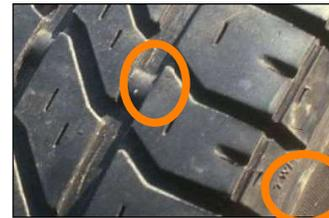
**Indikatoren:** Wenn die Indikatoren (Erhöhungen in den Rillen des Reifenprofils) mit dem Profil eine Ebene Fläche bilden ist der Reifen zu wechseln.
